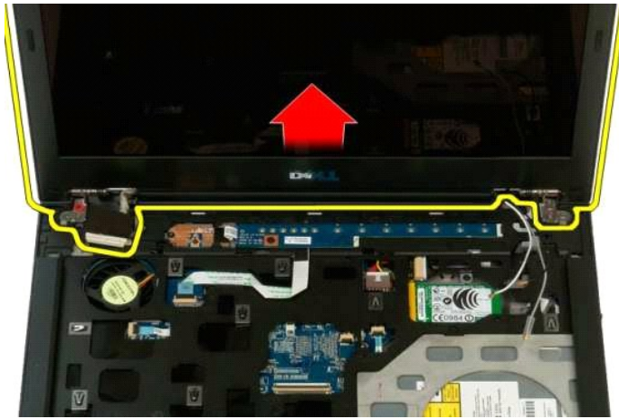
12. Angkat dan lepas rangkaian display dari komputer.
