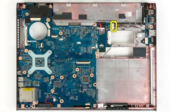
20. Lepas kabel daya dari board sistem.
