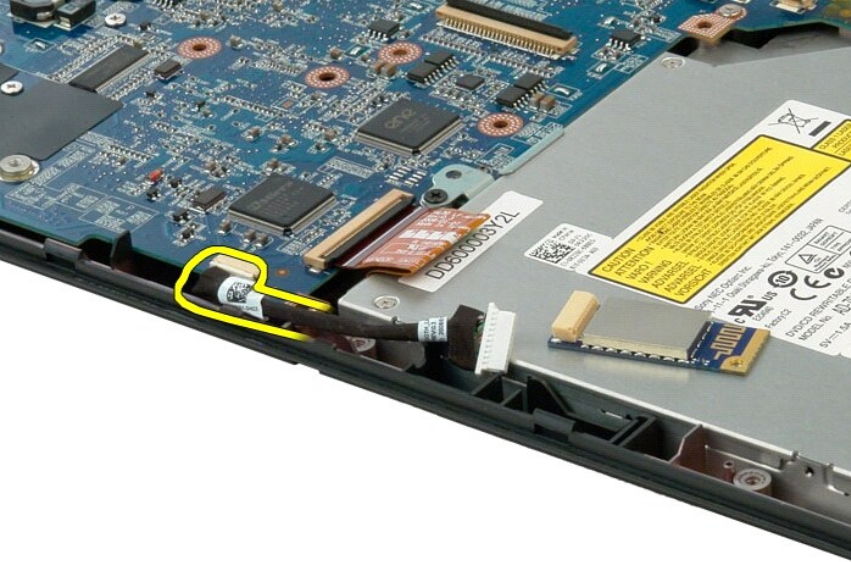
14. Lepas kabel data dari komputer.
