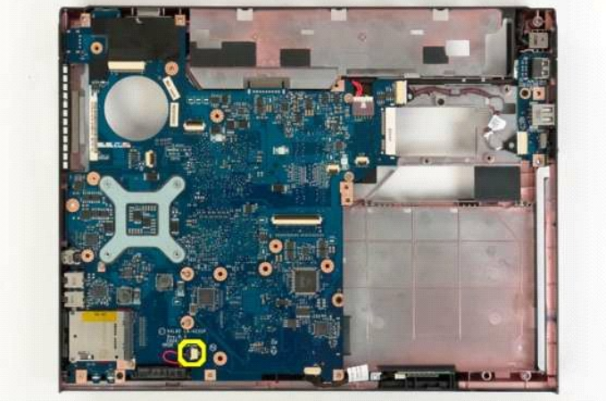
18. Lepas kabel data dari board sistem.
