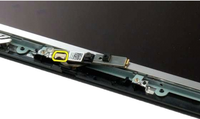
7. Lepas kabel data kamera display.
