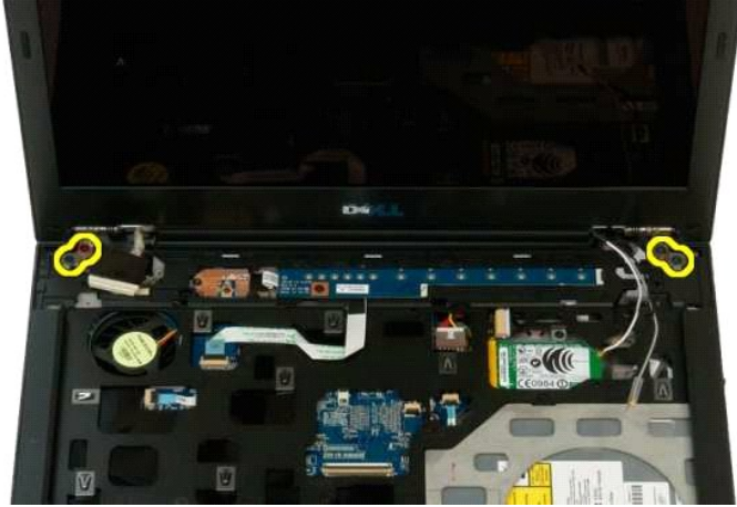
12. Angkat dan lepas rangkaian display dari komputer.
